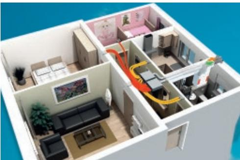
FlexPipe Plus – Das flexible Luftverteilsystem mit höchstem Komfort
